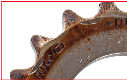
Зірочки - зона контакту з ланцюгом, зношування зубців зірочки.
