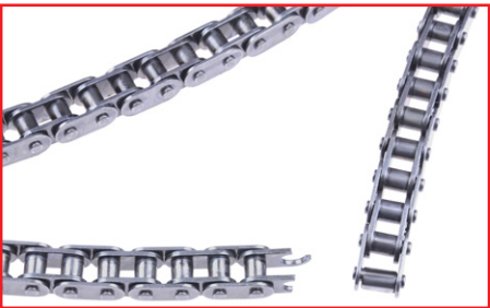
Ланцюг - зношування відбувається переважно на осях та втулках.
