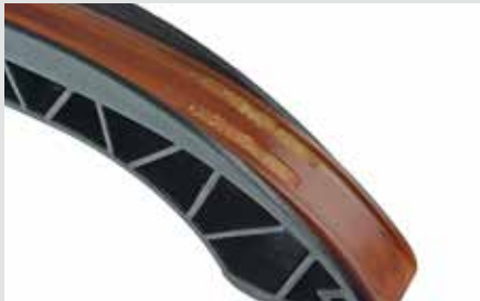
Направляючі рейки - зношуються разом з іншими компонентами, прорізаючи канавки у направляючій поверхні.
