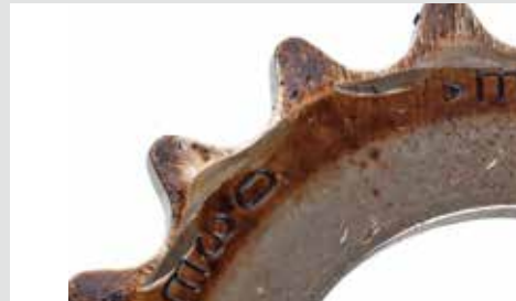
Зірочки - зона контакту з ланцюгом, зношування зубців зірочки.
