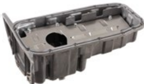
Олійний піддон із зливною пробкою
